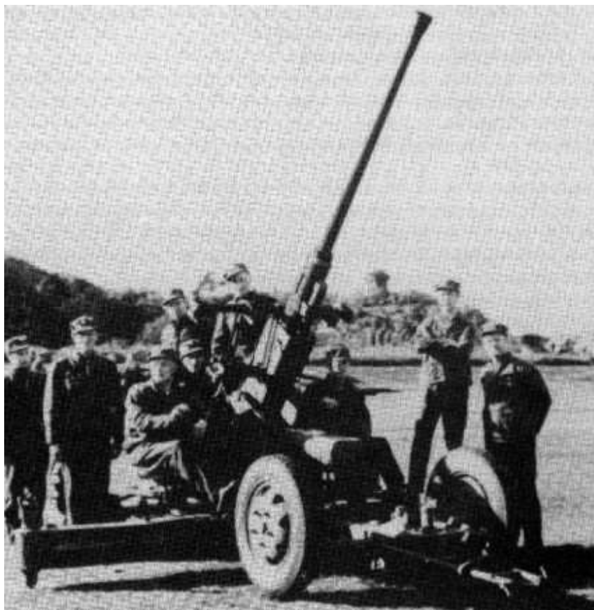
Joonis 9. 40 mm Bofors ’i õhutõrjekahur laskekorras ( Norwegian weapons ).
